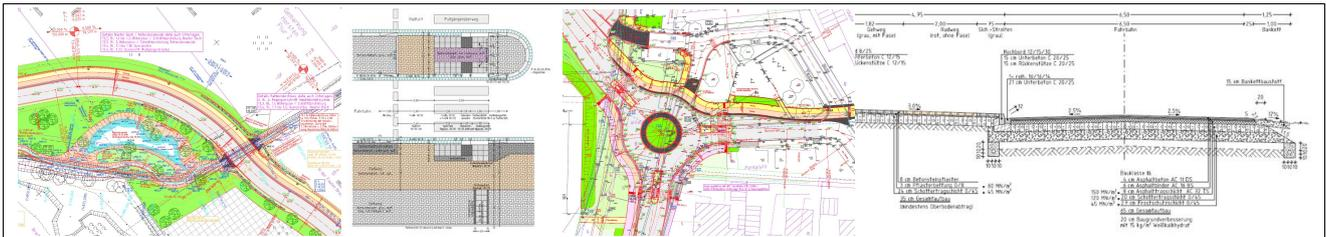
**Aufgabenstellung:** Innerörtliche Hauptverkehrsstraße, ca. 500 m, Anbindung mittels KVP, Umlegung eines Bahnhofsparkplatzes, Neustrukturierung Geh-/Radwege zur Bahnhofsanbindung, Querungshilfen, Gestaltung eines Regnrückhaltebeckens sowie einer Retentionsmulde mit Gewässerumlegung, Anlage eines Amphibienleitsystems an Querung Hasster Bach
